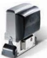
**001BX-78** Автоматика, укомплектованная электронной платой, встроенным радиодекодером, датчиком для контроля движения и обнаружения препятствий и механическими концевыми выключателями для откатных ворот весом до 800 кг.
